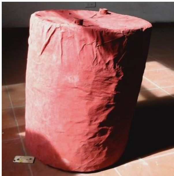
Figura 4.37 Termotanque del calentador solar con base en lentes de Fresnel.
