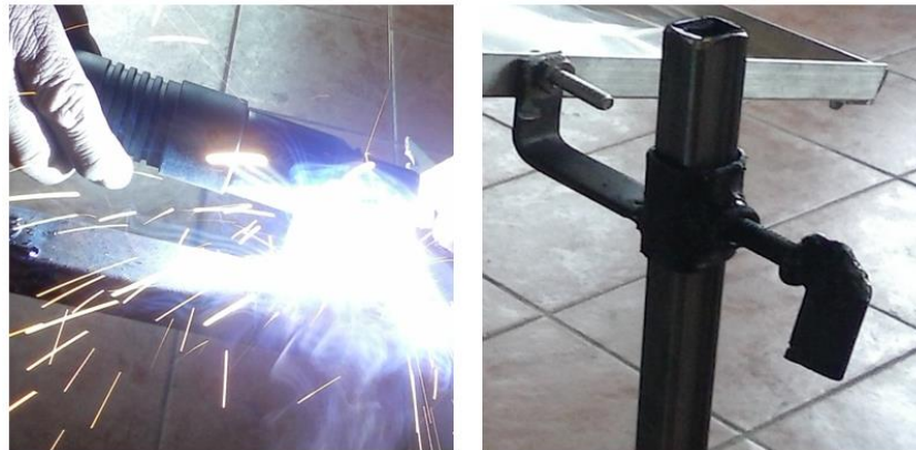
Figura 4.42 Soldadura de solera en la prensa.
