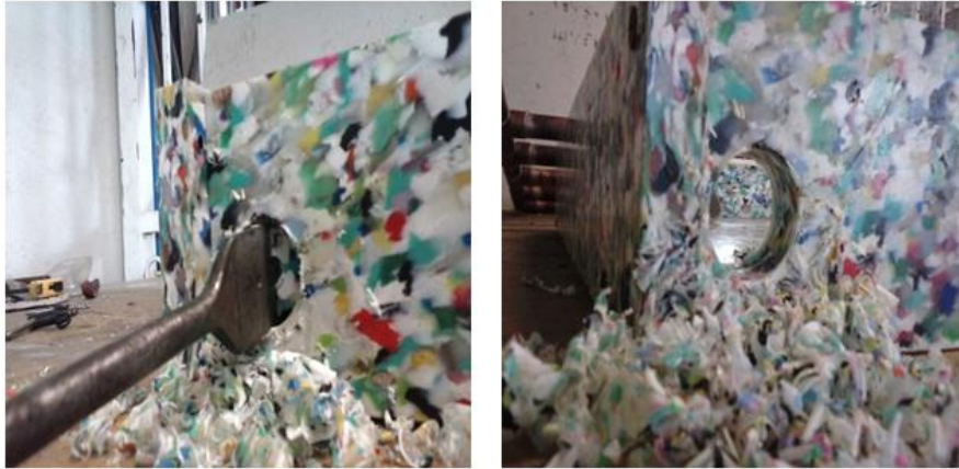
Figura 4.22 Perforación lateral del cajón.
