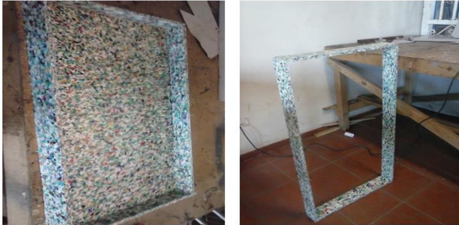
Figura 4.20 Armado del cajón de plastitabla.
