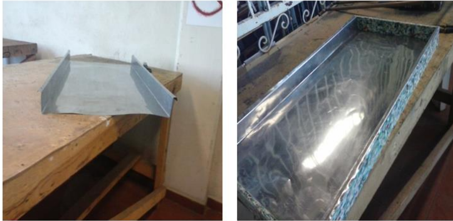
Figura 4.24 Doblado y colocación de la lámina en el cajón.
