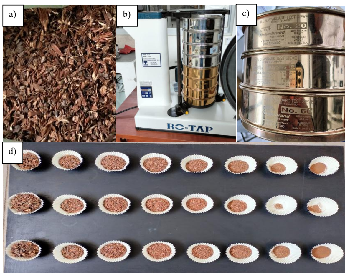
Figura 3.6. a) Conos de pino triturados, b) Tamizador RC-TAP RX-29, c) Tamices ASTM E-11 STANDAR (No 20, 40, 60), d) Distribución granulométrica.
