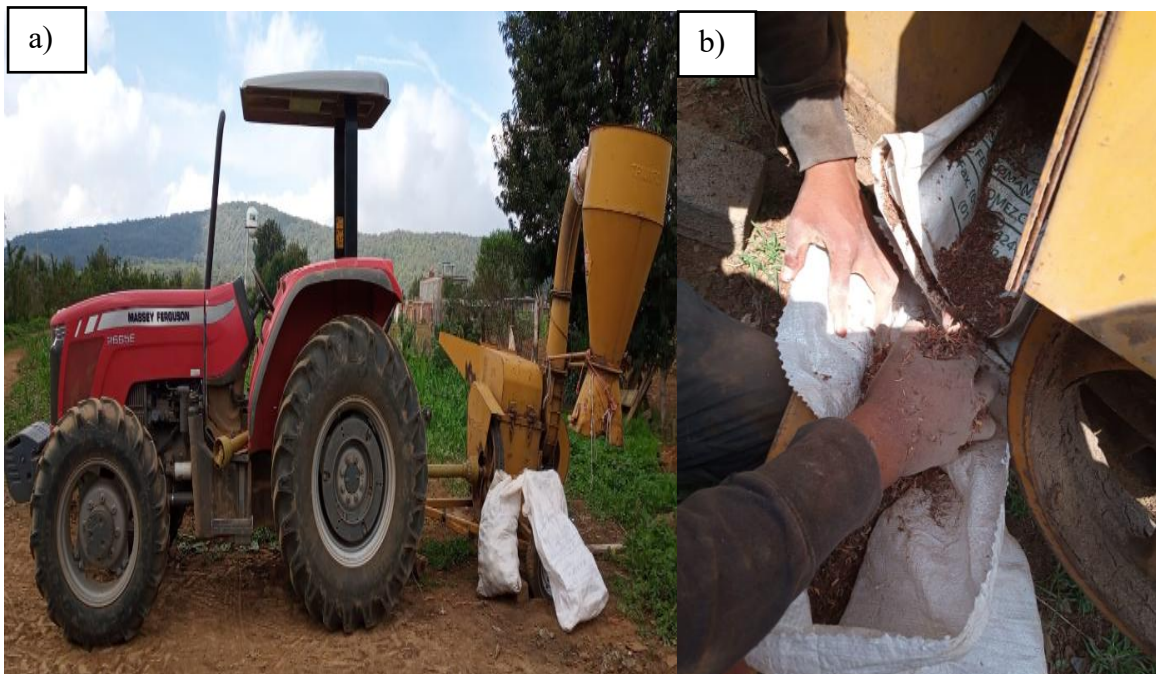
Figura 3.5. a) Molino de martillos anclado a un tractor Massey Ferguson, b) conos de pino triturados.
