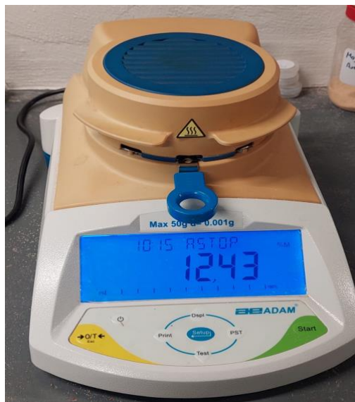
Figura 3.4. Balanza para cálculo de porcentaje de humedad (imagen propia)
