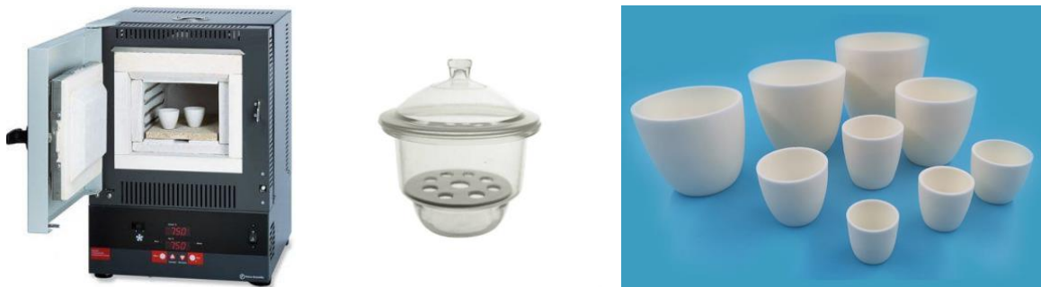
Figura 3.6. Equipo para determinación de contenido de cenizas
