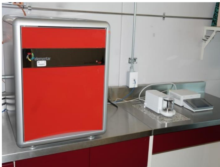
Figura 3.7. Analizador CHNS/O: Elementar Vario EL Cube
