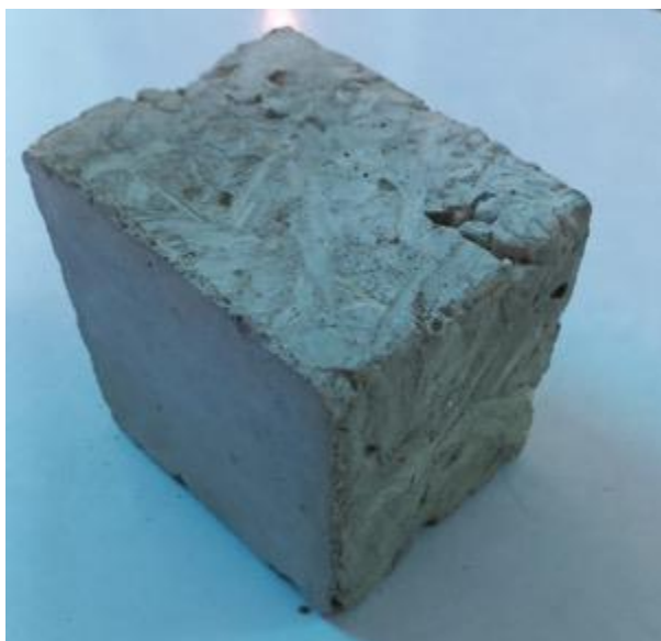
Figura 3.6. Cubo de concreto de 10x10 cms con un espesor de 2 cm. Fuente Propia
