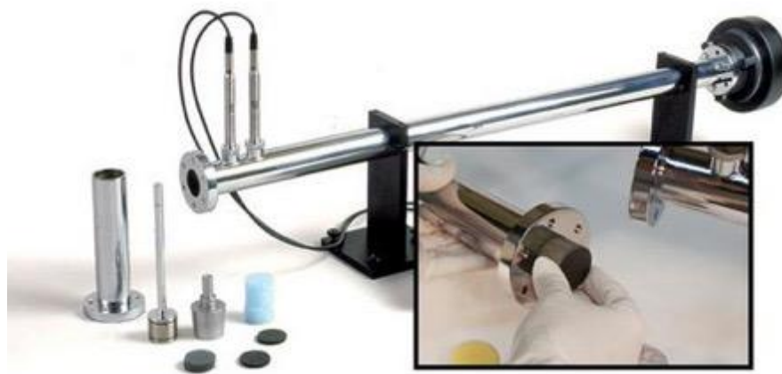
Figura 2.8. Los tubos de impedancias (tubos de Kundt), son sistemas para el estudio y obtención de las propiedades acústicas de los materiales ensayados.
