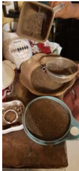
Figura 3.5. Triturado y cribado de sargazo. Fuente propia.
