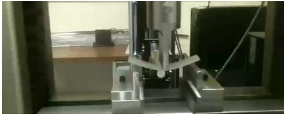
Figura 2.10. Dispositivo de flexión colocado en la máquina universal Zwick Z050 [54]
