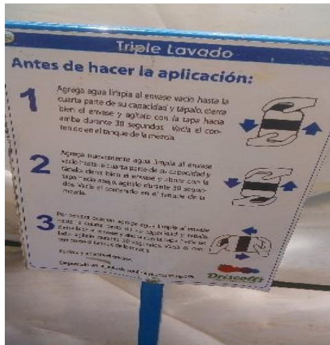
Figura 44.- Procedimiento para triple lavado.
